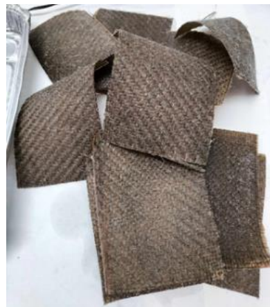
Figuur 15: gedelamineerd vlas/bio PU composiet
