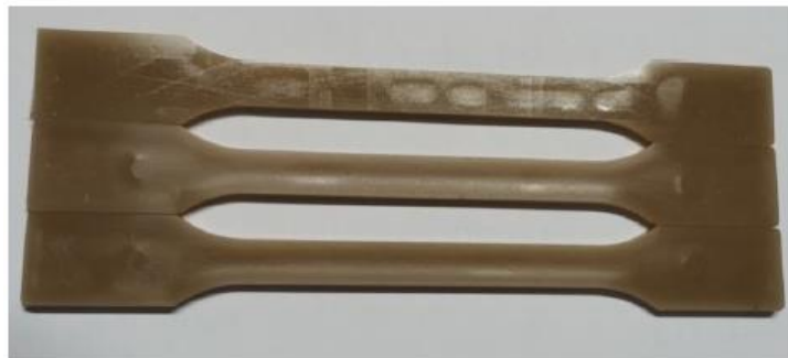
Figuur 13: PLA trekstaafjes met vlas/epoxy recyclaat
