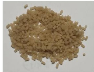
Figuur 12: PLA compound met vlas/epoxy recyclaat
