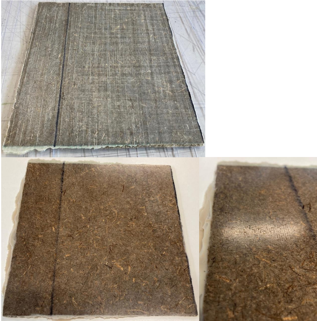
Figuur 3: Bovenaan 'voor', onderaan links 'na' en onderaan rechts 'na + vergroot'. Herconsolidatie van krasbeschadiging met hydraulische pers met persdruk van 1,5 bar, maximale perstemperatuur van 180°C en 5 minuten op maximale perstemperatuur.
