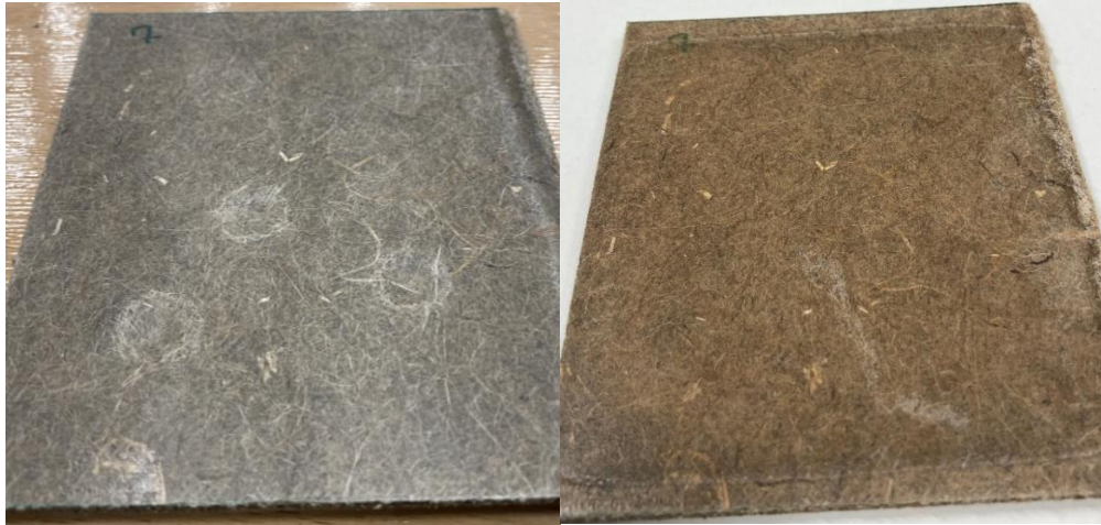
Figuur 7: Resultaat van een hersteltest van een deukbeschadiging met de pneumatische pers, links = 'voor'; rechts = 'na'
