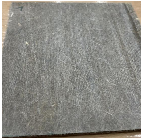
Figuur 5: Startbeschadiging op de non-woven hennep-PP plaatjes voor de herstelling met de pneumatische pers
