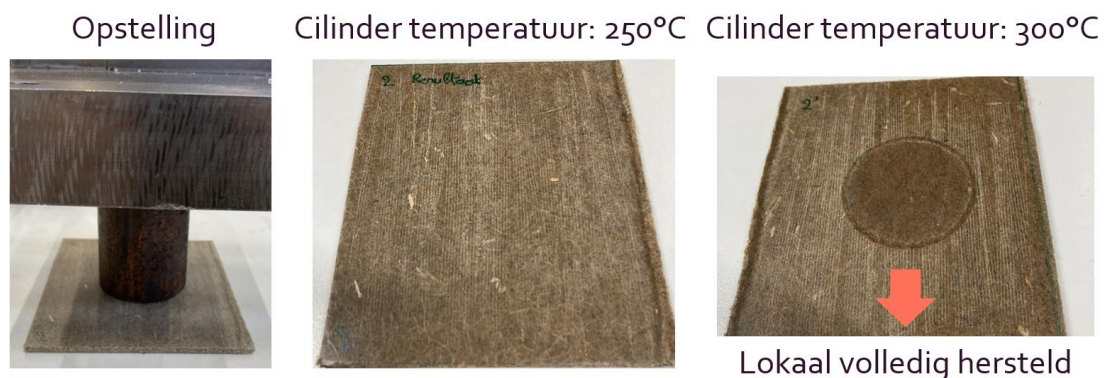
Figuur 8: Opstelling en resultaten van een lokale herstelling door de druk van een warme cilinder
