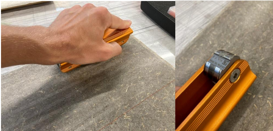
Figuur 1: Aanbrenging van krasbeschadiging met krasmes
