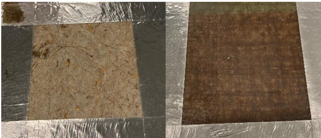
Figuur 25: Uitzicht van de plaatjes met klassieke biocoating na een QUV-cyclus; links = sample met lijnzaadolie coating, rechts = sample met wax coating
