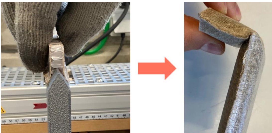
Figuur 6: Het dichtlassen van sandwichpanelen als randafwerking voor de kruk en opstapdemonstrator, eerste set-up op kleine schaal
