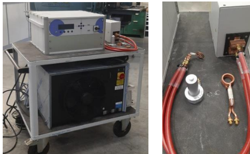
Figuur 12: Inductiegenerator (Cobes) en spoel die gebruikt zijn om onderstaande testen uit te voeren
