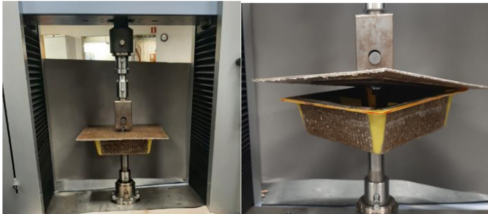
Figuur 18: Mechanische sterkte test van de inductielasverbinding in de trekbank
