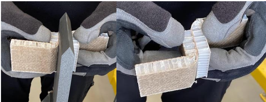
Figuur 4: Voorbeeld van een spiegellastest met een vlas-PP sandwichpaneel
