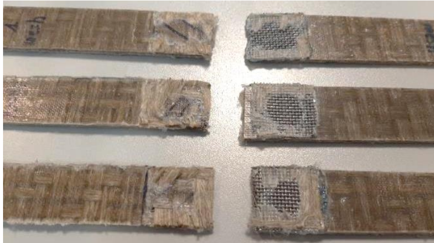
Figuur 16: Overlapoppervlaktes van de vlas-PLA samples na afschuivingstest op de trekbank
