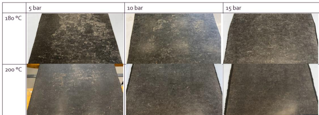
Figuur 11: Resultaten van variatie in perstemperatuur en persdruk voor non-woven hennep-PP
