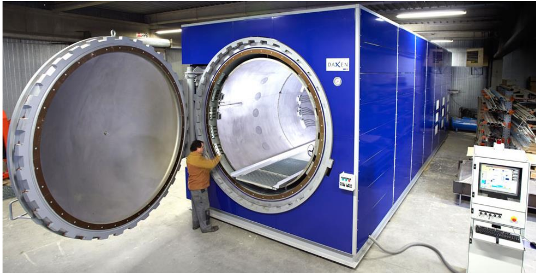
Figuur 25: Voorbeeld van een autoclaaf [21]
