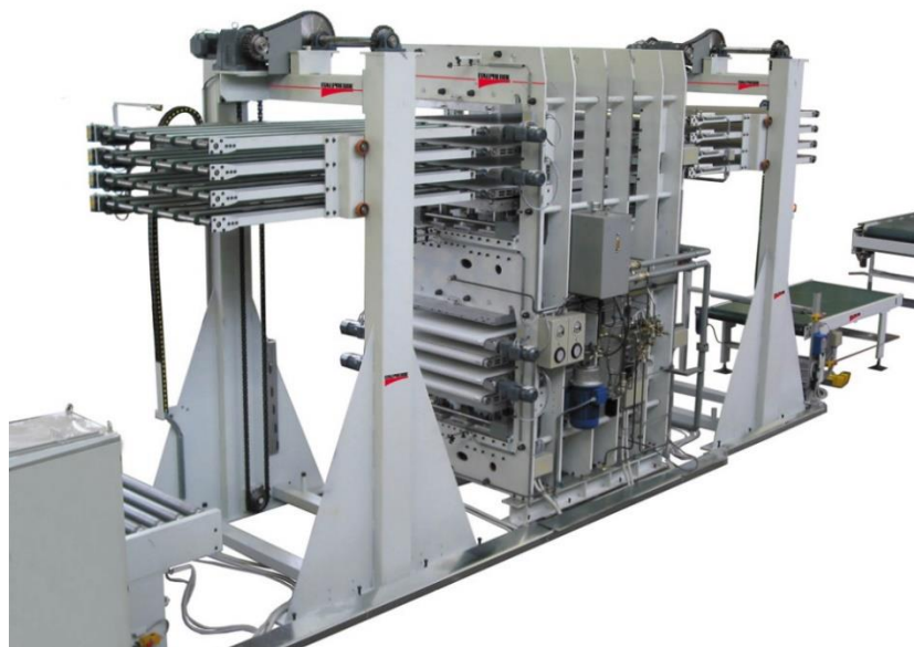
Figuur 18: Voorbeeld van een multi-daylight pers voor de productie van thermoplastische composieten platen [11]
