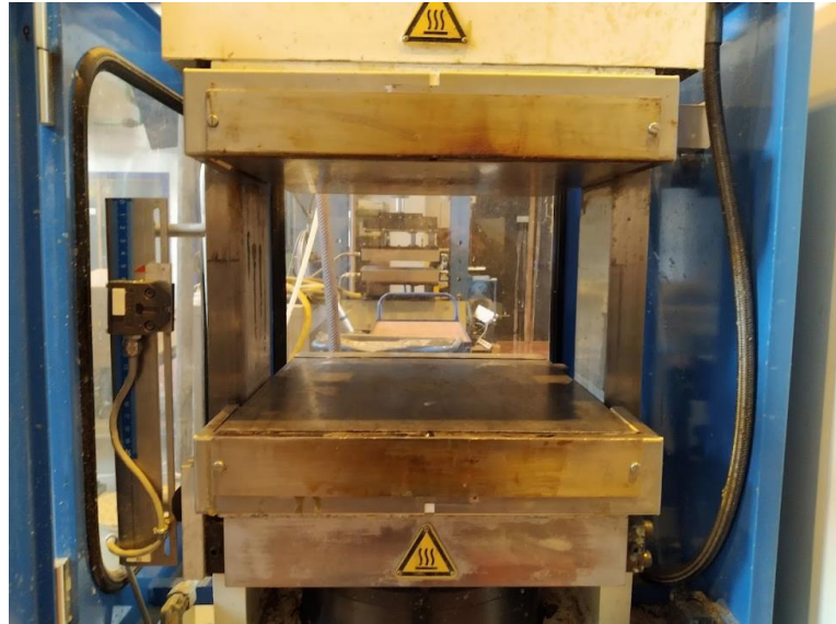
Figuur 6: Voorbeeld van een pers geschikt voor thermocompressie tot 2D-plaatmateriaal
