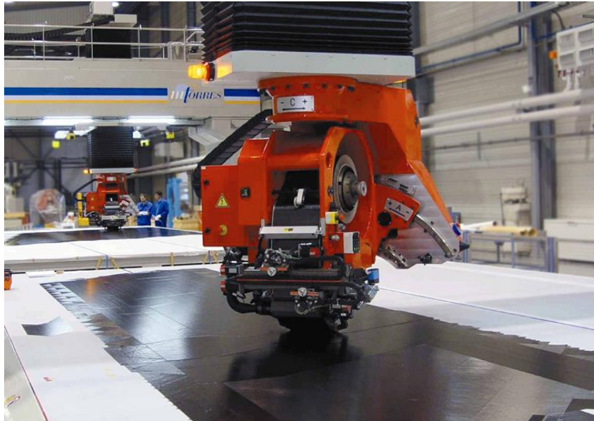
Figuur 19: Voorbeeld van een automated tape laying proces [12]
