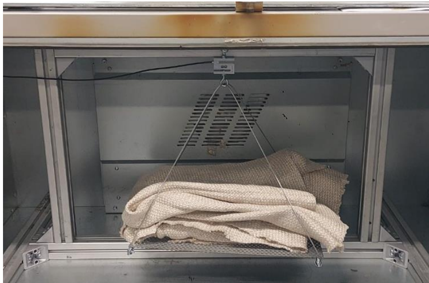
Figuur 1: Opstelling van het vlas-PLA weefsel tijdens een droogtest
