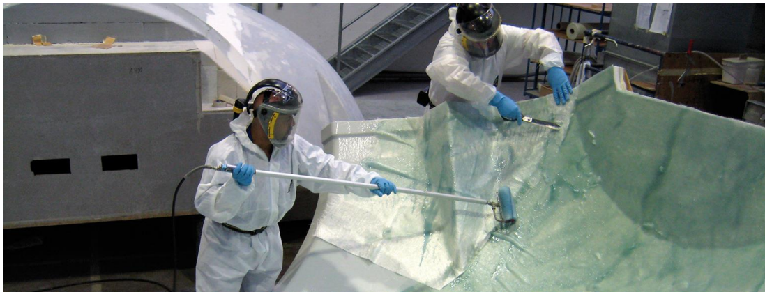
Figuur 39: Voorbeeld van de productie bij een hand lay-up proces [31]
