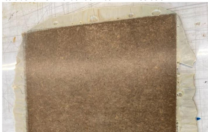
Figuur 15: Resultaat consolidatietest vlas-PLA 40/60 met 10 bar persdruk en 200°C perstemperatuur
