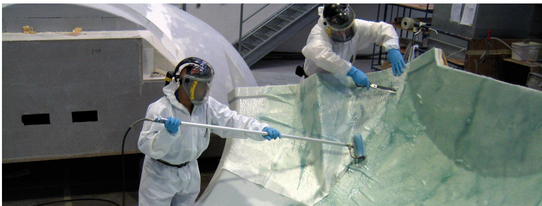
Figuur 21: Voorbeeld van de productie bij een hand lay-up proces [16]
