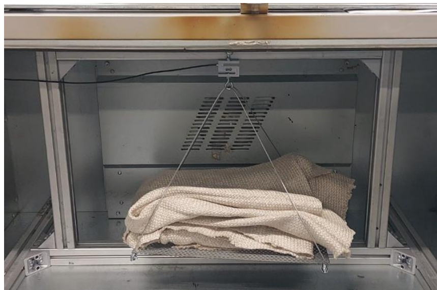
Figuur 1: Opstelling van het vlas-PLA weefsel tijdens de droogtest
