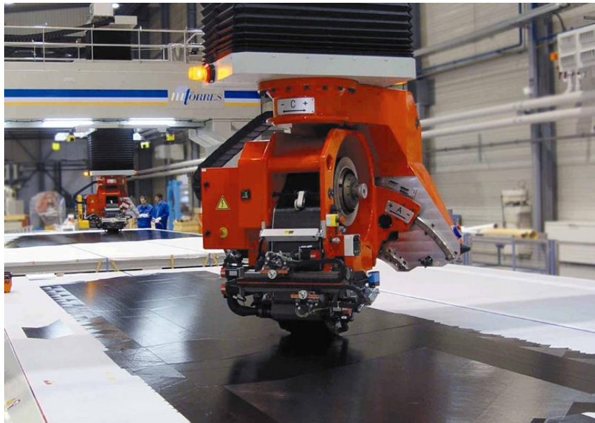
Figuur 14: Voorbeeld van een automated tape laying proces [11]
