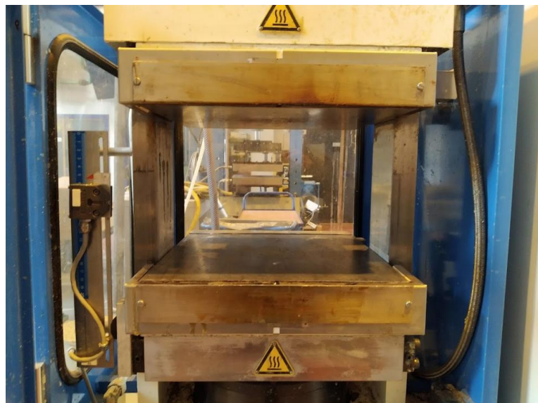
Figuur 3: Voorbeeld van een pers geschikt voor thermocompressie tot 2D-plaatmateriaal
