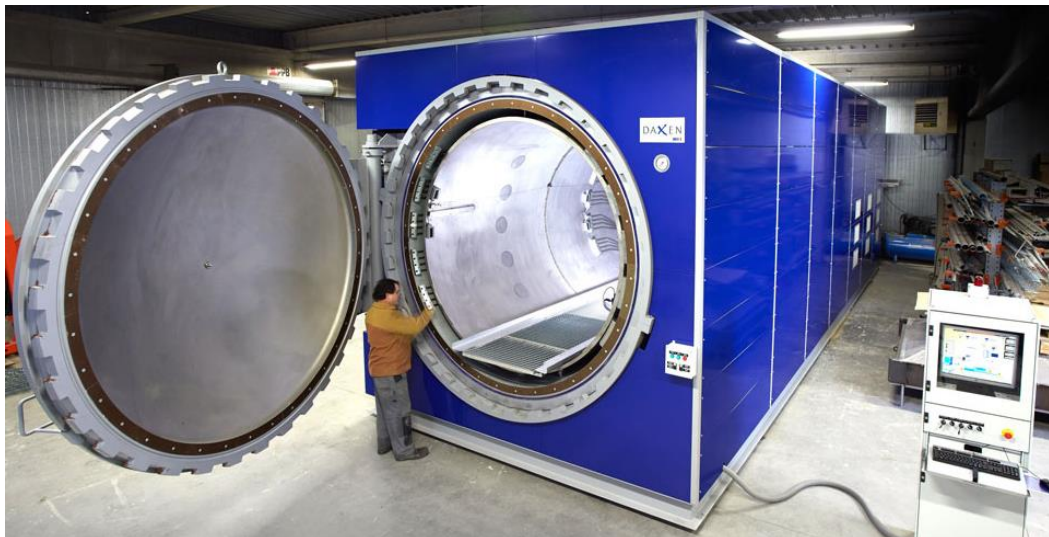
Figuur 10: Voorbeeld van een autoclaaf [9]
