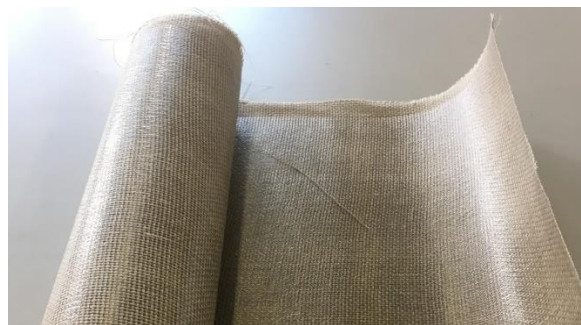
Figuur 1: PLA coating op vlas
