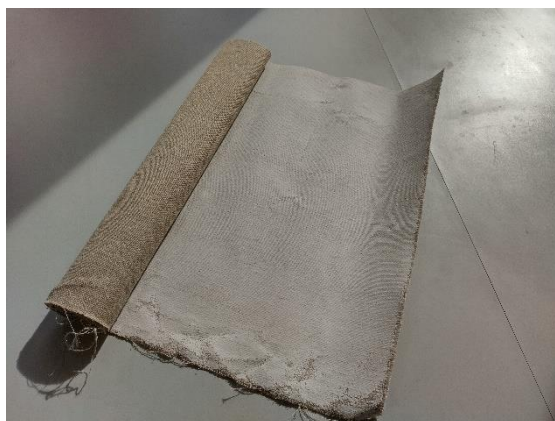
Figuur 4: PLA dispersie aangebracht op vlas
