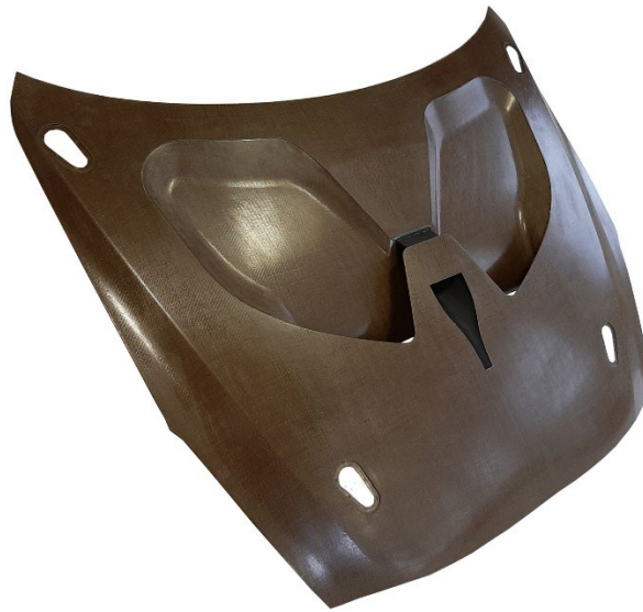
Figuur 21: motorkap in vlascomposiet 19
