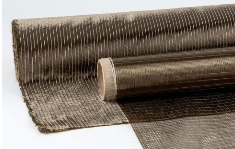
Figuur 24: multi-axiaal basalttextiel 20
